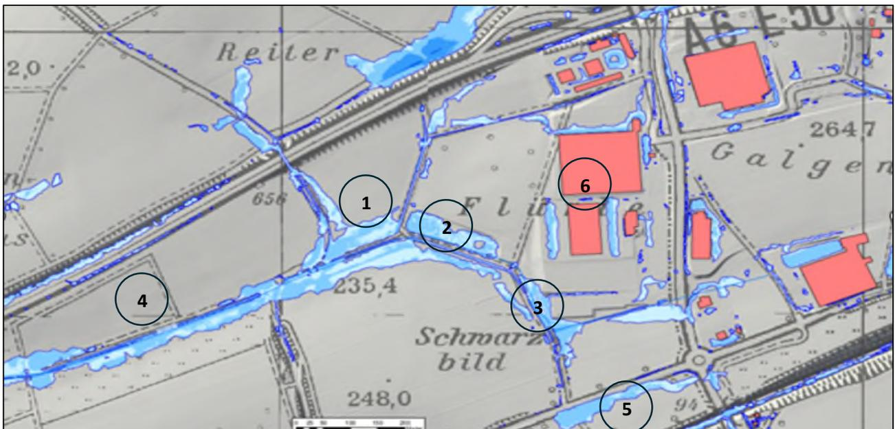
Abbildung 4: Die Überflutungstiefe im Bestandsgelände „Wammesfeld“ für das Szenario „selten“. Die Farbgebung stellt von hellblau nach dunkelblau die Überflutungstiefen „5 cm – 10 cm“, „10 cm – 50 cm“, „50 cm – 1m“ sowie „> 1 m“ dar.<sup>4,5</sup>
