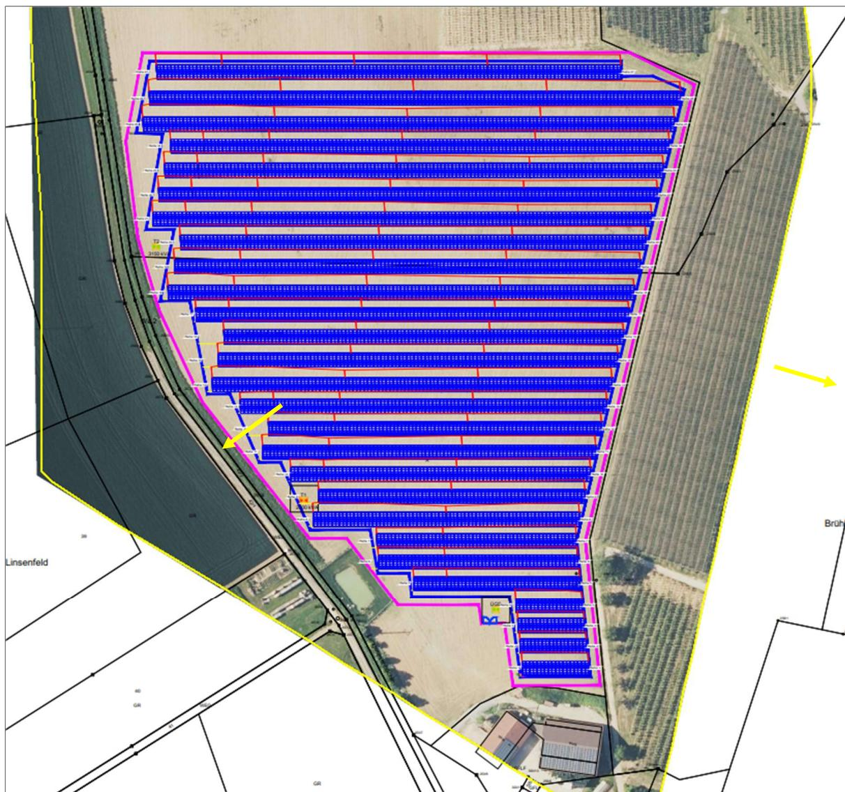
**Abb. 2:** Entwurf eines Modulbelegungsplans (Ersteller: SPM GmbH)
