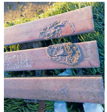
Eingebrannte Stellen in der Bank Fotos: Stadt Öhringen
